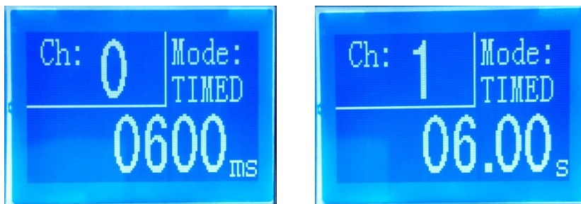
그림 3 [TIMED] 패턴, 정시시간단위 분별 s와 ms 의 표시계면
