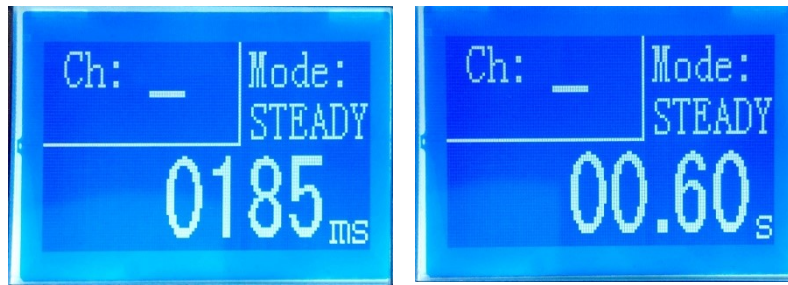
그림 4 [STEADY]패턴, 토출시간단위 분별 s와 ms의 표시 계면
