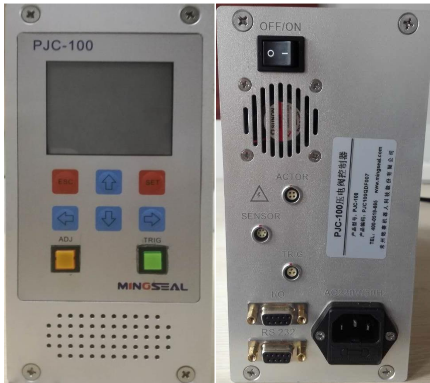
사진 1 PJC-100 뒷면 패널 및 연결 예시
